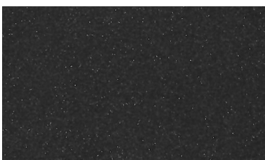
DB703 Dunkelgrau Gris foncé 5803E71386A10 glatt, matt, Perlglimmer, PG 1 lisse, mat, mica nacré, PG 1
